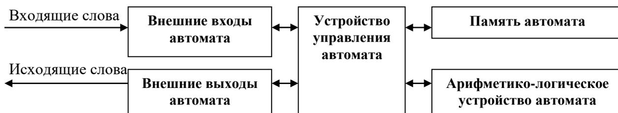
**Состояние автомата** – состояние входов, выходов, памяти, арифметико-логического устройства и устройства управления автомата в определенное время:
